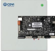
Pour la gestion des ascenseurs, transformez le contrôleur A22 en A22EC avec la mise à jour du micrologiciel. Pour cela, il est nécessaire d'ajouter les modules ascenseurs CAA480ATR.
