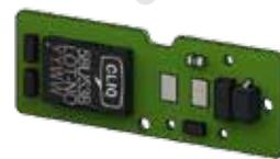
La nouvelle génération de puce CLIQ® offre un cryptage AES, une vitesse rapide de traitement et une gestion performante de l'énergie.
